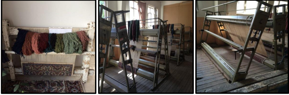
Şekil 4, 5 ve 6. Halı dokuma tezgâhları
