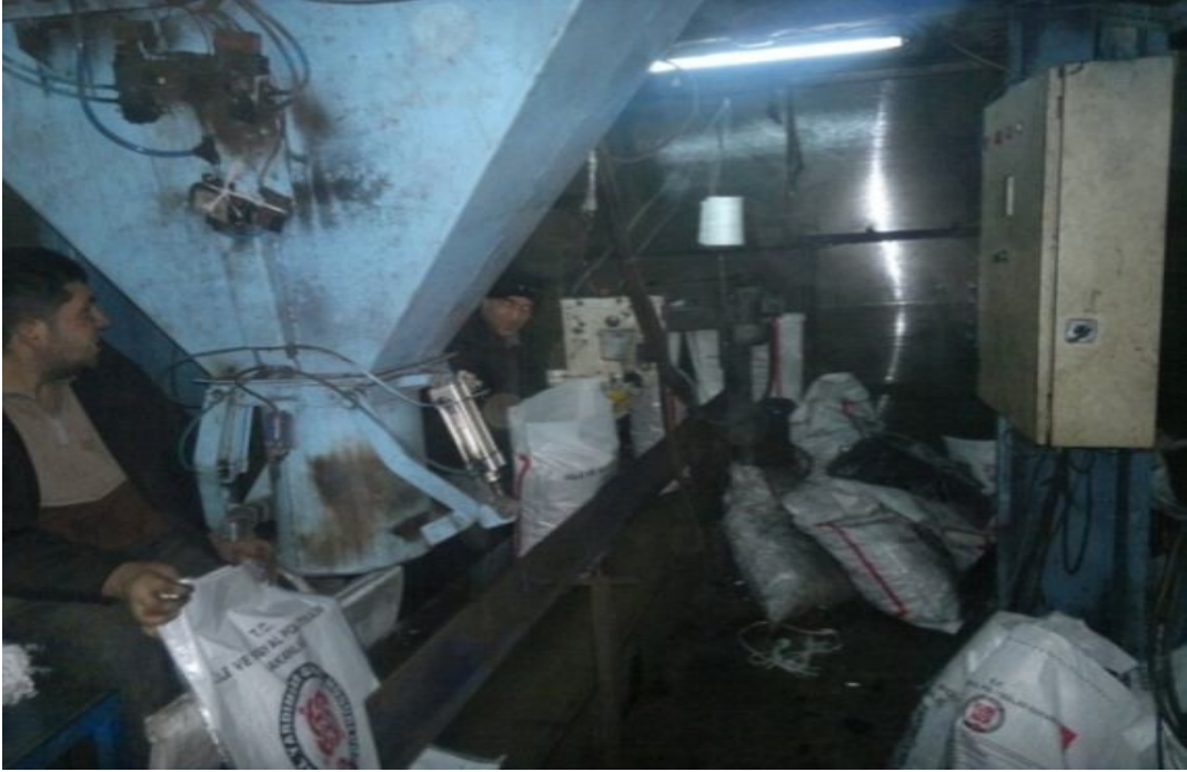
Şekil 5.2 Mevcut durumdaki tesiste torba takma işlemi.
