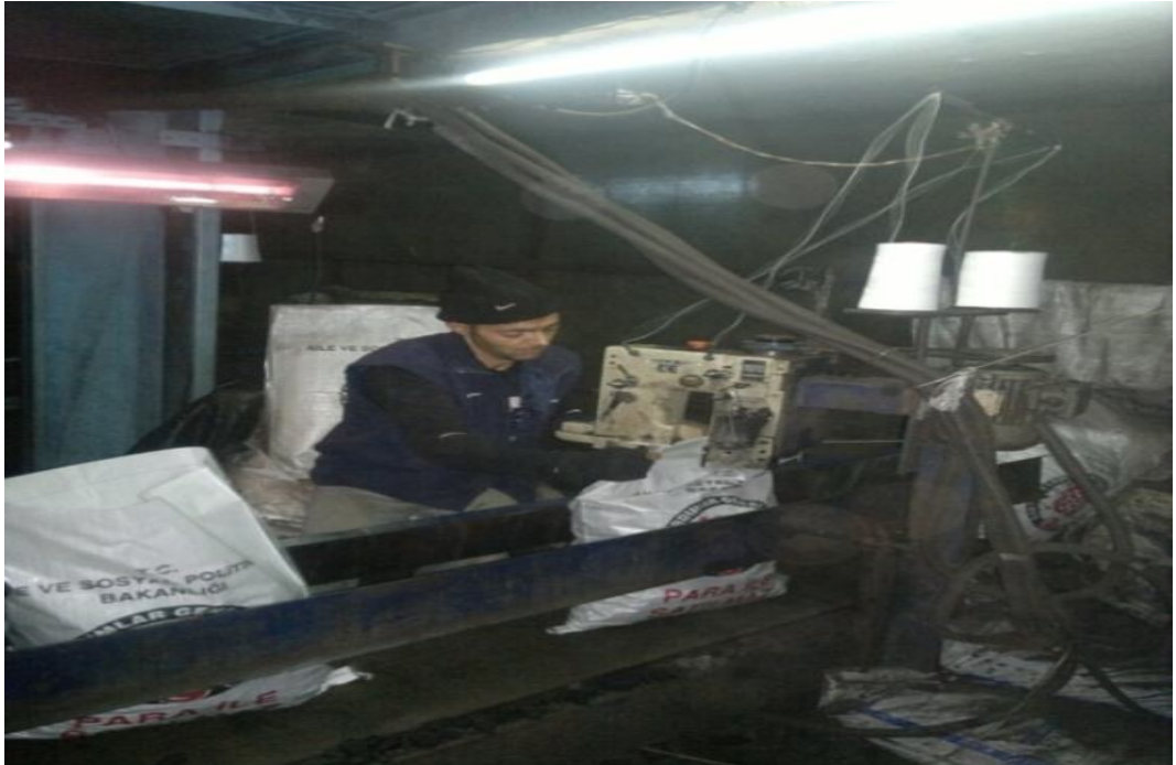
Şekil 5.6 Mevcut durumdaki tesiste torba dikme işlemi.
