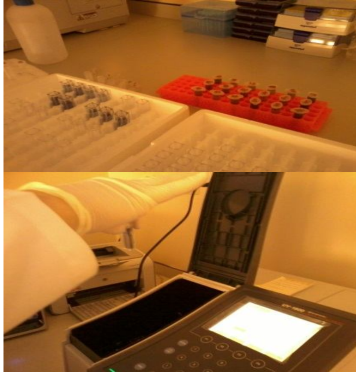
Şekil 3.5. Süpernatantın spektrofotometre cihazında ölçülmesi
