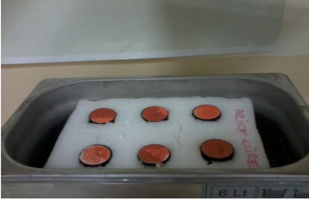
Şekil 3.2. Şişelerin ultrasonik banyoda ekstraksiyona konulması
