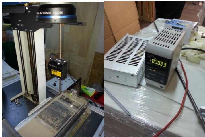
Şekil 4.2 - Keyence LK-G157 lazer mesafe sensörü
