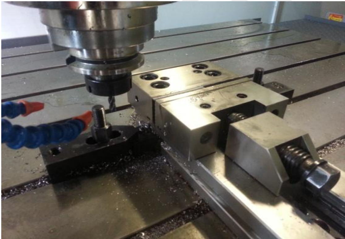
Şekil 45. Deney parçasının talaşlı üretim tezgahında işlenmesi
