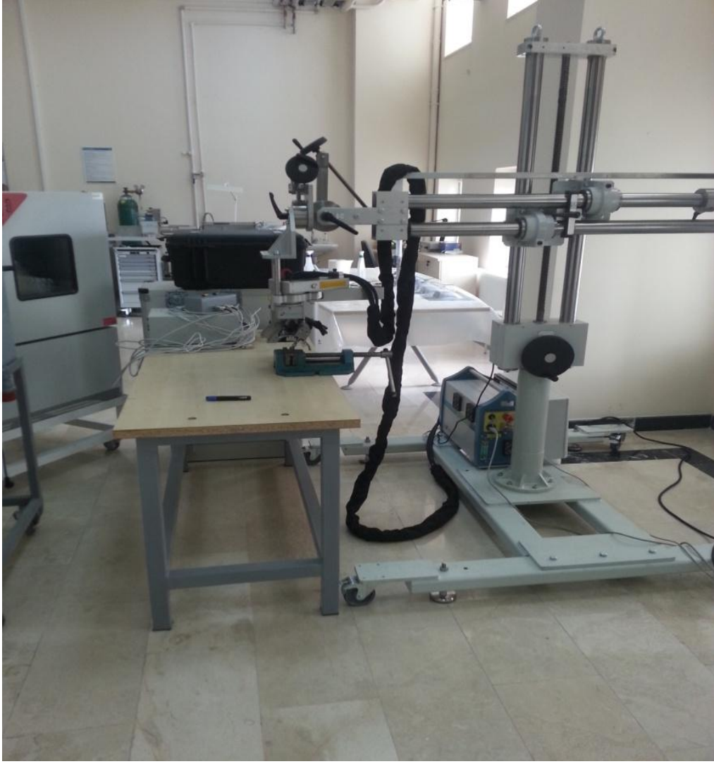
Şekil 33. X ışını yöntemiyle kalıntı gerilme ölçümlerinin yapıldığı XRD cihazı
