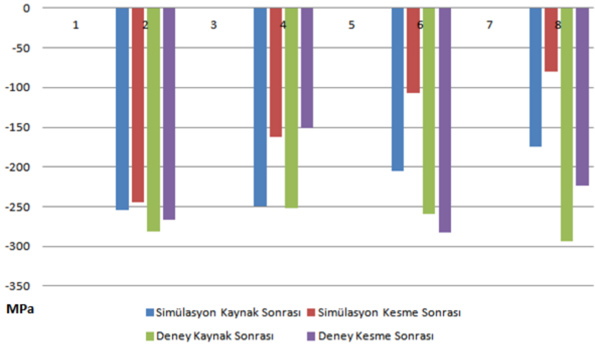
Şekil 58. Simülasyon ve x ışını yöntemi ile elde edilen kalıntı gerilme değerleri grafiksel gösterimi
