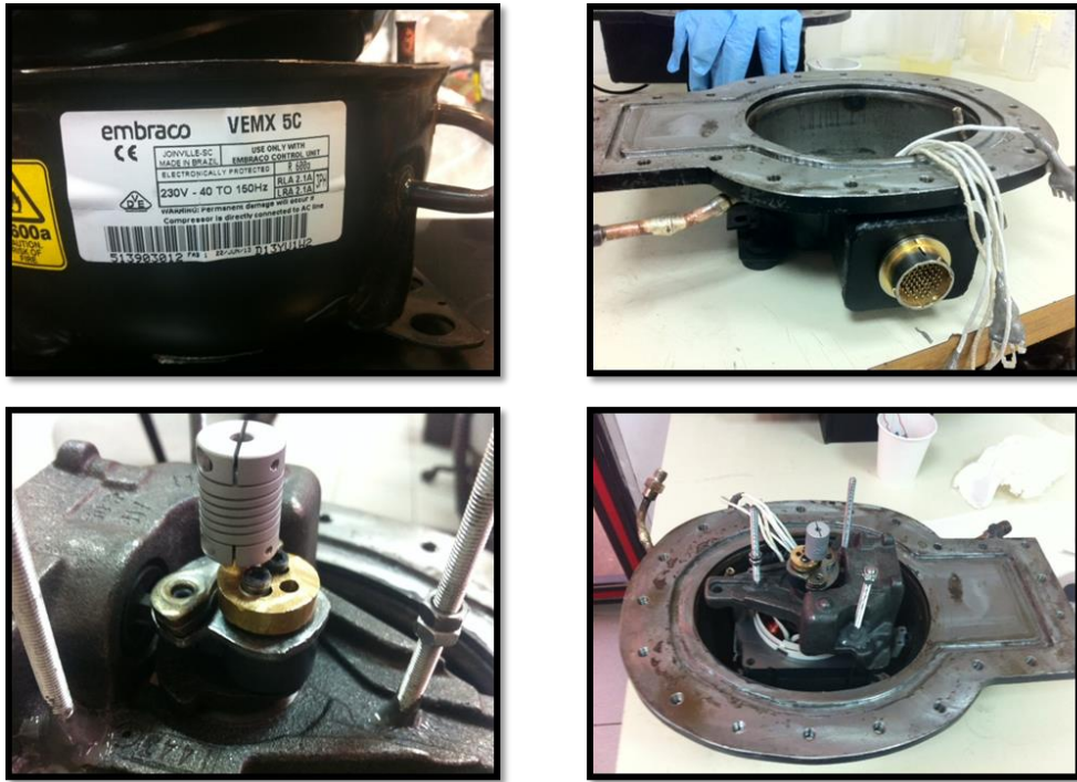
Şekil 3.44 : Rakip B pV hazırlık çalışmaları.
