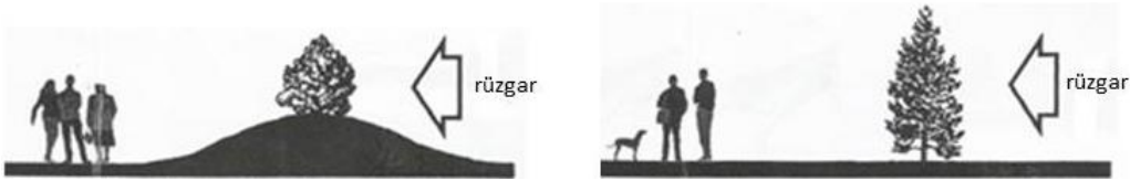
Şekil 4.7. Yapay topoğrafya ya da boylu sık dokulu bitki kullanımı ile rüzgar kontrolünün sağlanması (Robinette, 1983)
