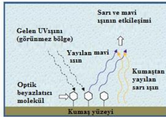
Şekil 2.16 : Optik beyazlatıcının kumaş yüzeyinde çalışması [11].
