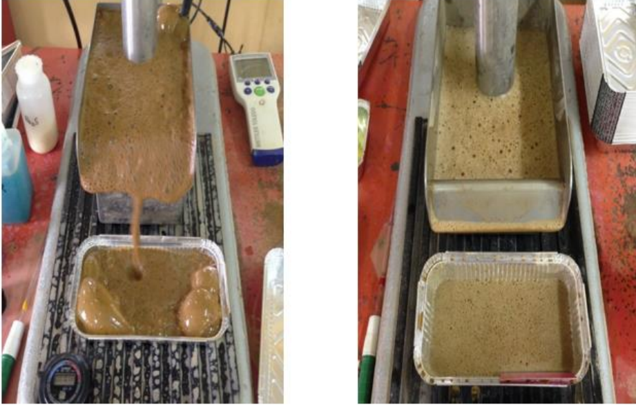
Şekil 3.8. Öğütülmüş numune ile flotasyon testi (İlk konsantre alımı ve test sonu)
