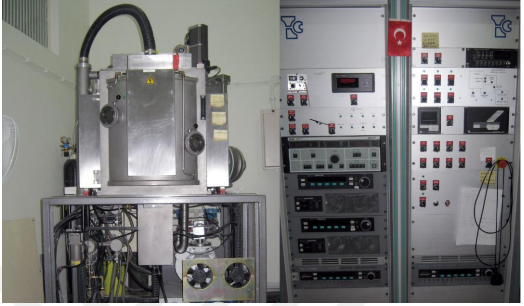
Şekil 3.2. kaplamaların büyütülmesi için kullanılan PVD kaplama ünitesi
