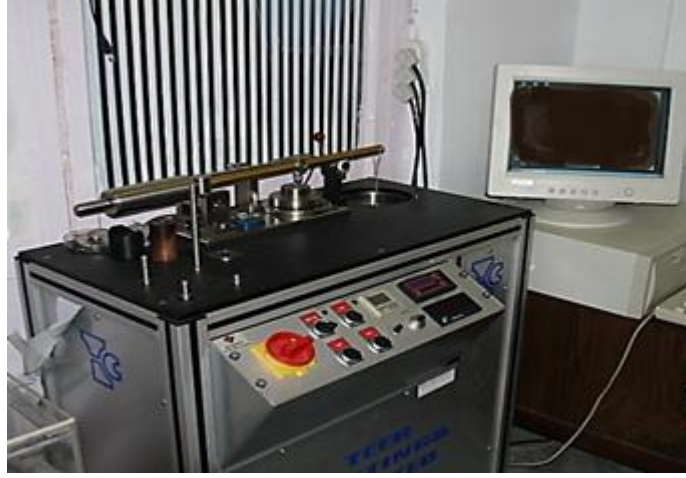
Şekil 3.7. Teer-Tribotest sistemi pin-on-disk aşınma cihazı
