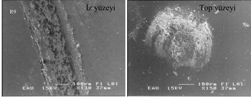
Şekil 4.34. R9 Kaplamanın sürtünme katsayıları ve aşınma izleri
