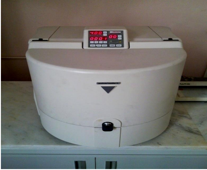
Şekil 5.2. FRITSCH Pulverisette 5 markalı gezegensel hareketli bilyeli değirmen.
