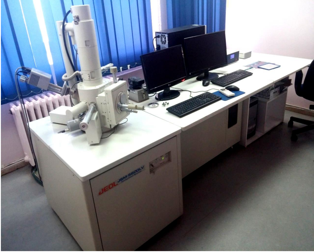
Şekil 5.6. JEOL JSM-5600LV markalı taramalı elektron mikroskobu cihazı.
