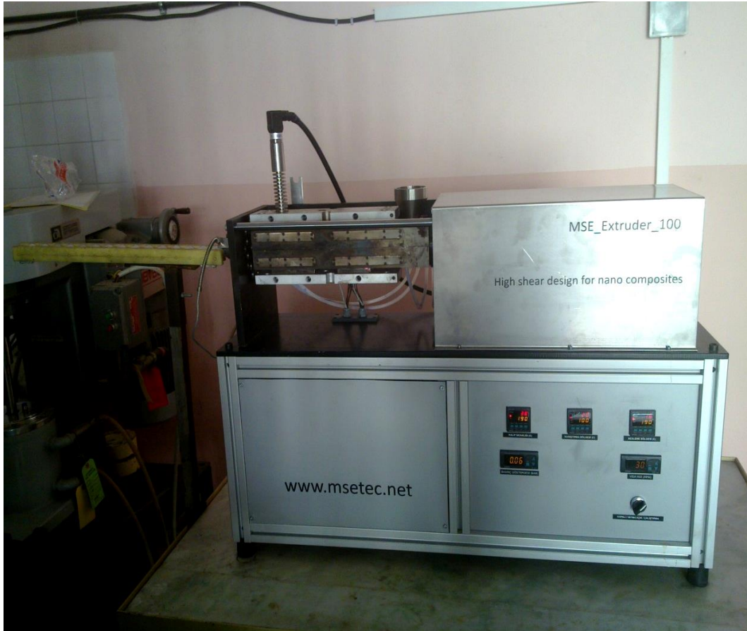
Şekil 5.4. MSE Extruder 100 markalı vidalı ekstrüzyon cihazı.
