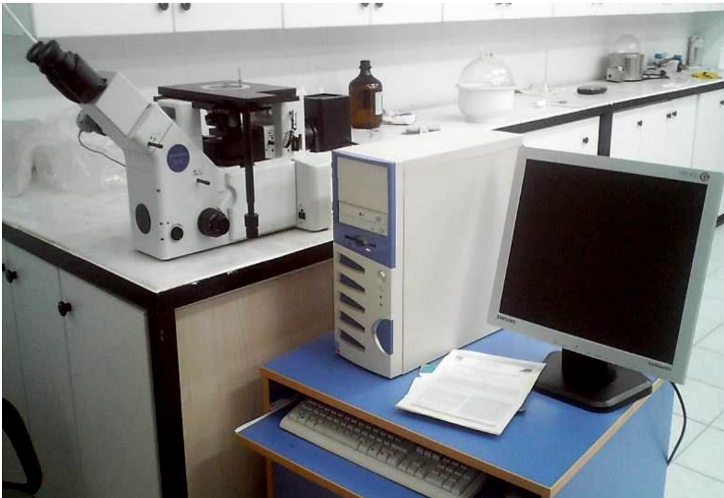
Őekil 5.5. Olympus GX51 markalı optik mikroskop cihazı.
