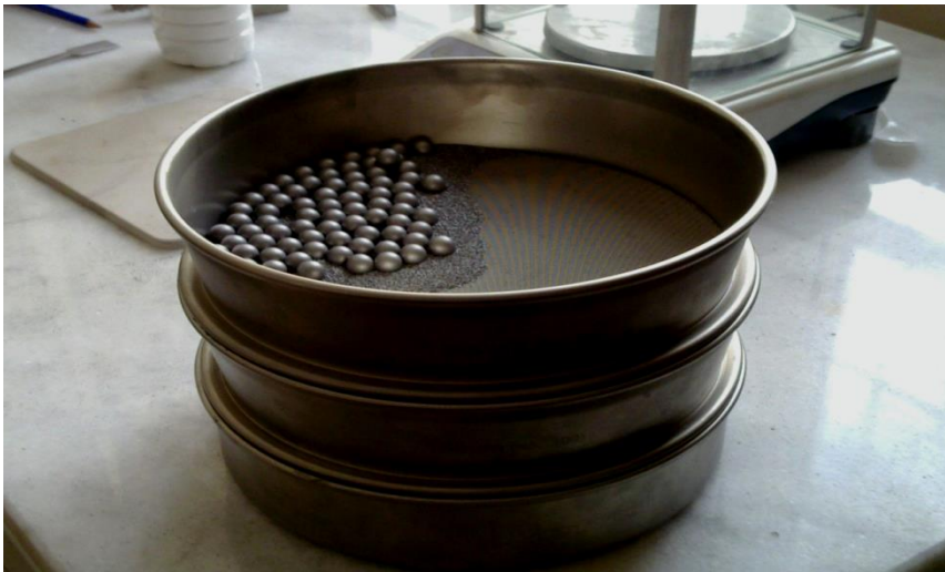
Şekil 5.3. Tozların 300 ve 150 \mu 'luk eleklerden geçirilmesi.
