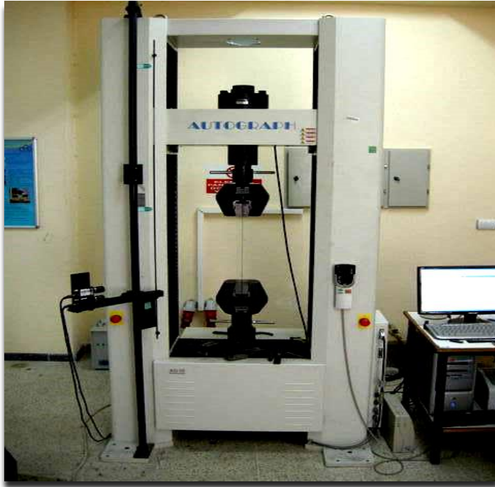
Şekil 5.9. Shimadzu AG-IS 250kN markalı basma testi cihazı.
