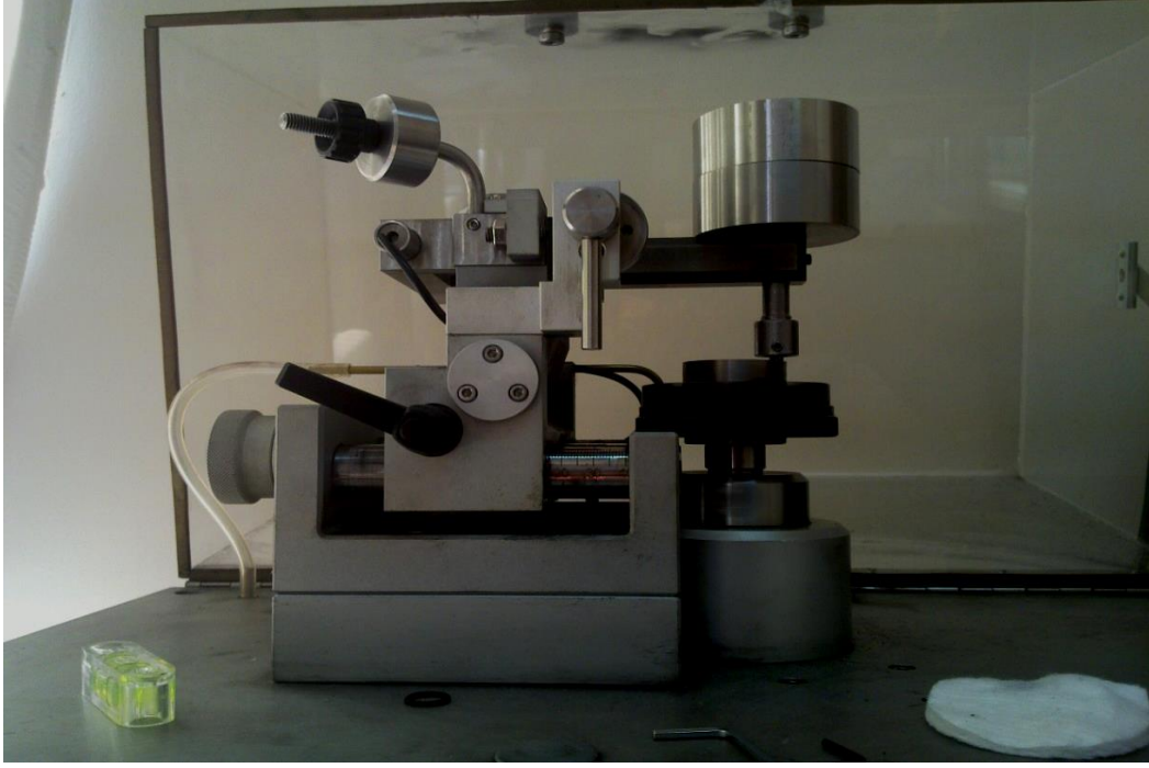
Şekil 5.7. CSM Tribometer markalı aşınma ve sürtünme cihazı.
