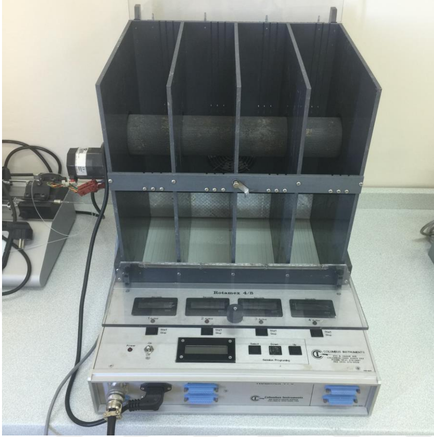
Şekil 14. Rotarod Performans Testi Düzeneği
