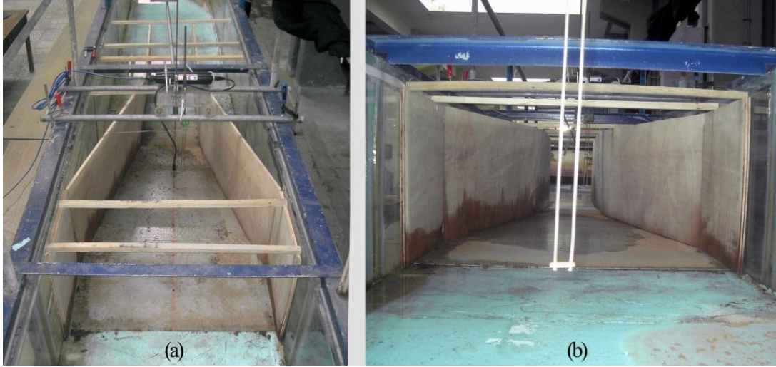
Şekil 3.5 : Kanal içerisinde yapılan kesit daraltması. (a) Üstten görünüş, (b) Kanal içerisinden görünüş.
