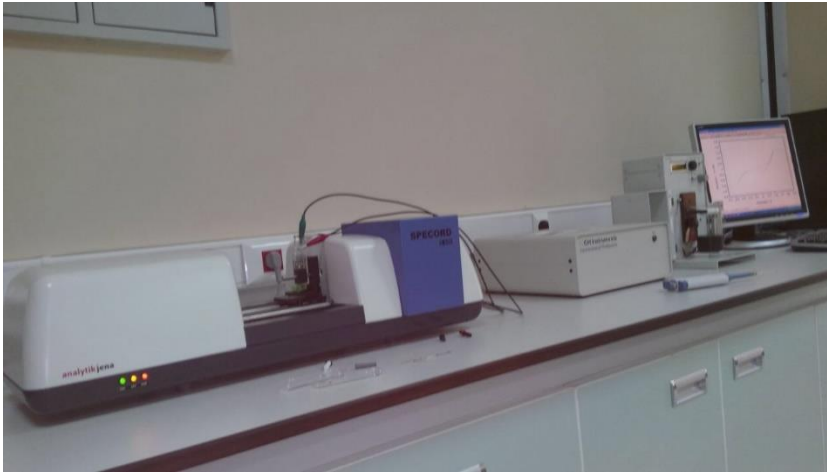
Şekil 3.5. Spektroelektrokimyasal ölçümler için kullanılan deney düzeneği
