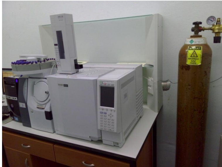
Şekil 3.13. Turunçgil türlerinde uçucu aromatik maddelerin analizinde kullanılan Shimadzu QP 2010 Plus GC-MS sistemi
