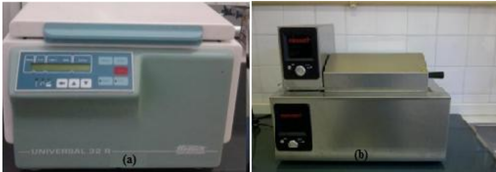
Şekil 3.2: (a)Universal 32R marka santrifüj; (b) Memmert marka çalkalayıcılı su banyosu.
