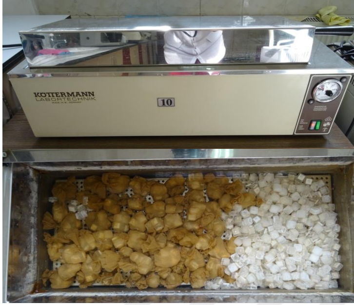
Resim 3.55. Etüv cihazı ve örneklerin etüv içerisindeki görünümü
