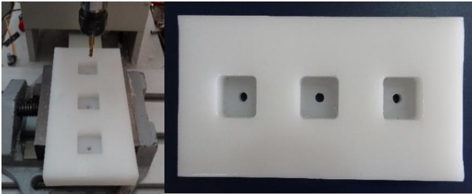
Resim 3.33. Polietilen kalıp ve torna cihazında hazırlanması
