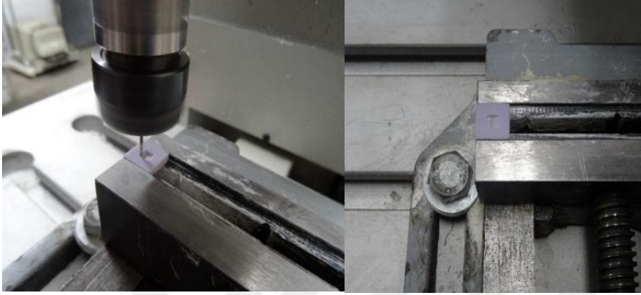
Resim 3.8. Lityum disilikat cam seramik CAD/CAM blok test örneklerinin merkezine torna cihazı kullanılarak kavite açılması
