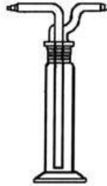
Şekil 5.2. Karbondioksit yöntemi ile baryum karbonat üretim metodunda kullanılan adsorpsiyon kabı
