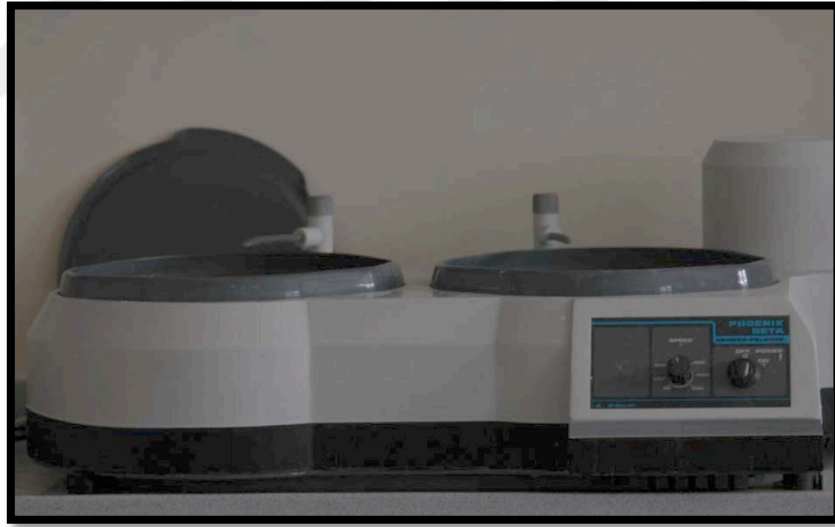
Resim 15. Çalışmada kullanılan aşındırma cihazı (Phoenix Beta, Buehler, USA).
