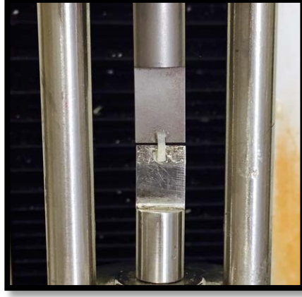
Resim 8. Elde edilen çubukların universal test cihazına bağlanması.
