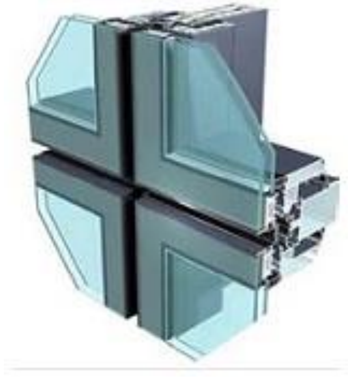
Şekil 2.7: Strüktürel silikon cephe sistemi detay resmi [9]
