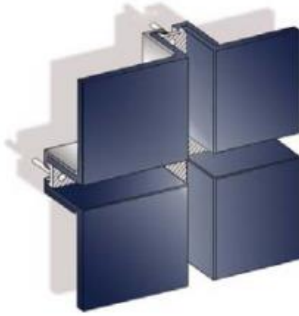
Şekil 2.9: Kompozit panel cephe sistemi [9]
