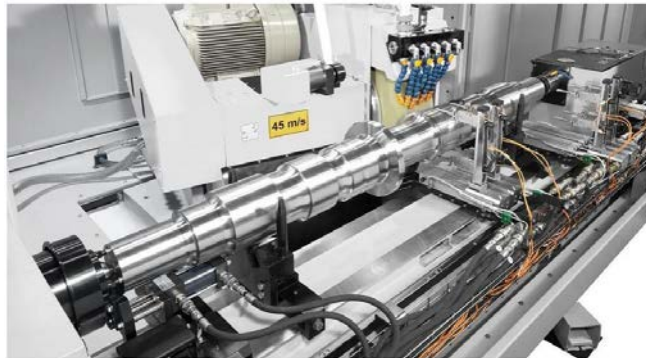
Şekil 3.7. Boyuna ve Enine Dış Yüzey Taşlama
