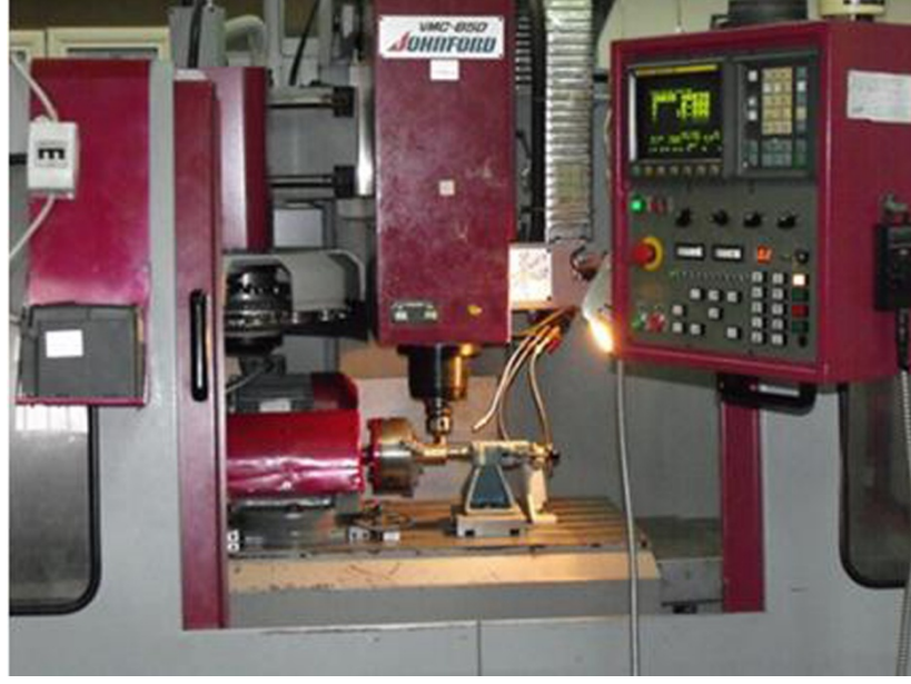
Şekil 4.1. Teğetsel silindirik taşlama deney düzeneği fotoğrafı
