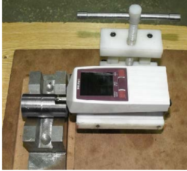
Şekil 4.5. Yüzey pürüzlülüğü ölçüm cihazı ve ölçüm düzeneği
