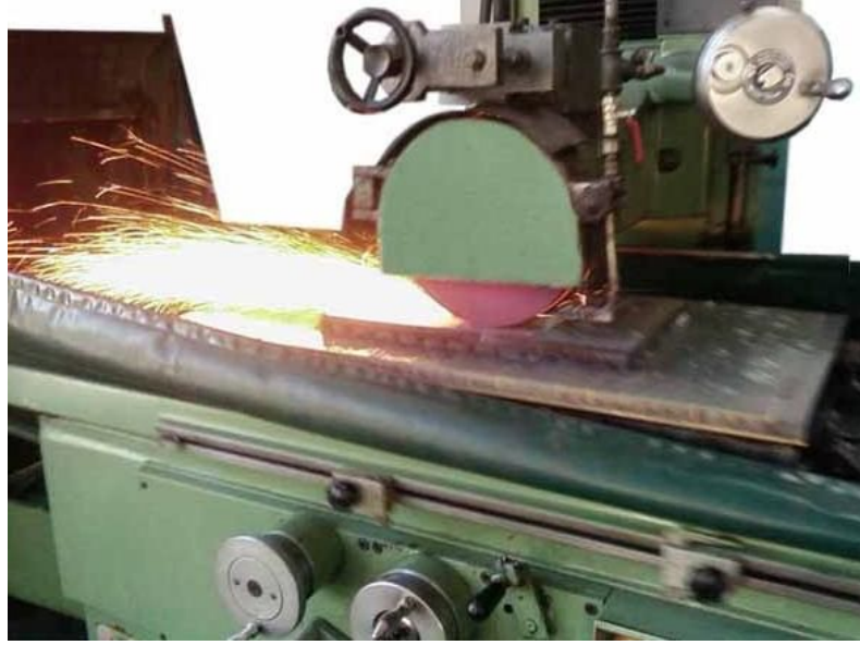
Şekil 3.4. Yatay Düz Yüzey Taşlama
