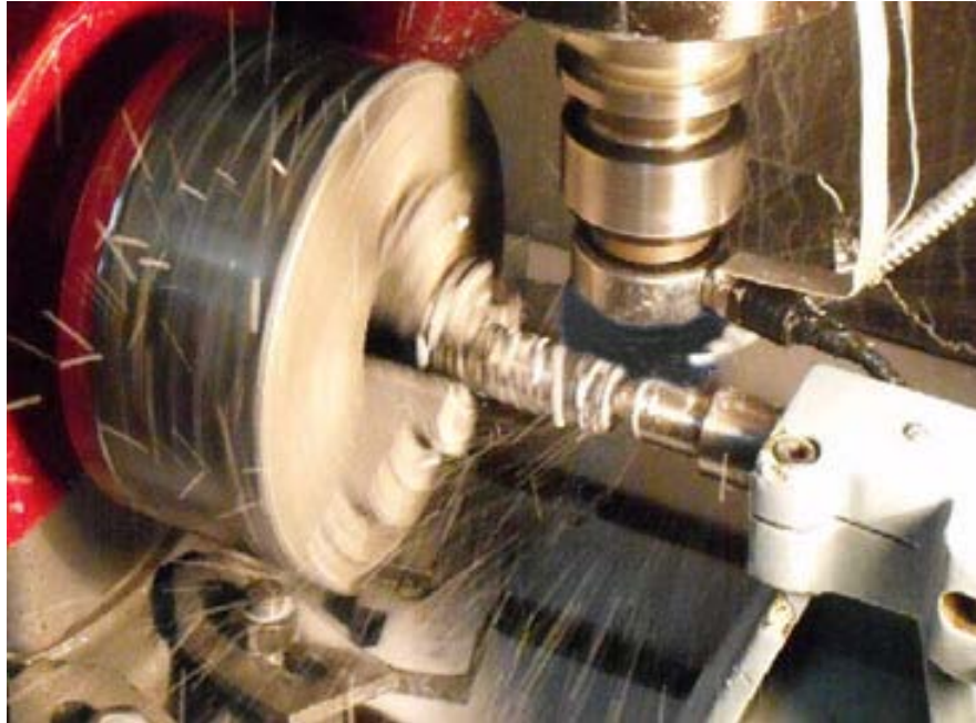
Şekil 4.2. Teğetsel silindirik taşlama yönteminde temas şekli
