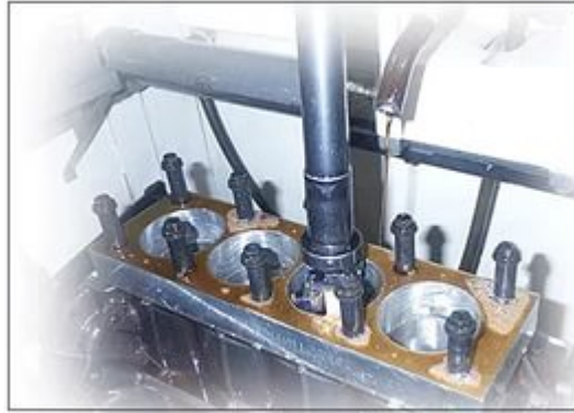
Şekil 3.5. Motor Bloklarının Taşlanması
