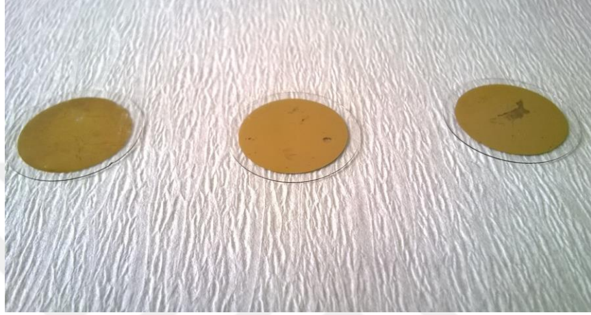
Şekil 4.21. Temizleme sonrası aşınan altın sensörler
