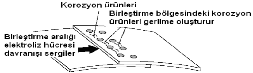
Şekil 2.15. Aralık korozyonu (Anonim 2015a)
