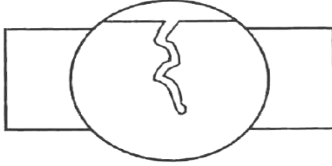
Şekil 2.24. Yorulmalı korozyonun Şematik gösterimi
