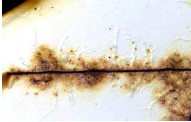
Şekil 2.18. Kabuk altı korozyonu (Zeren 2008)
