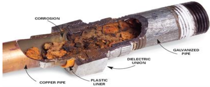
Şekil 2.17. Galvanik korozyona uğramış boru kesiti (Anonim 2009)
