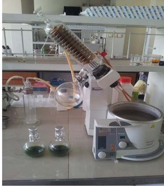
Şekil 3.7. Çözeltilerdeki metanol ve etanolün evaporatör ile buharlaştırılması
