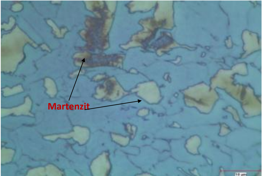
Şekil 4. 9 C bölgesi mikroyapı görüntüsü X1000 büyütme, MHO % 24 (Sıcaklık 225 °C)
