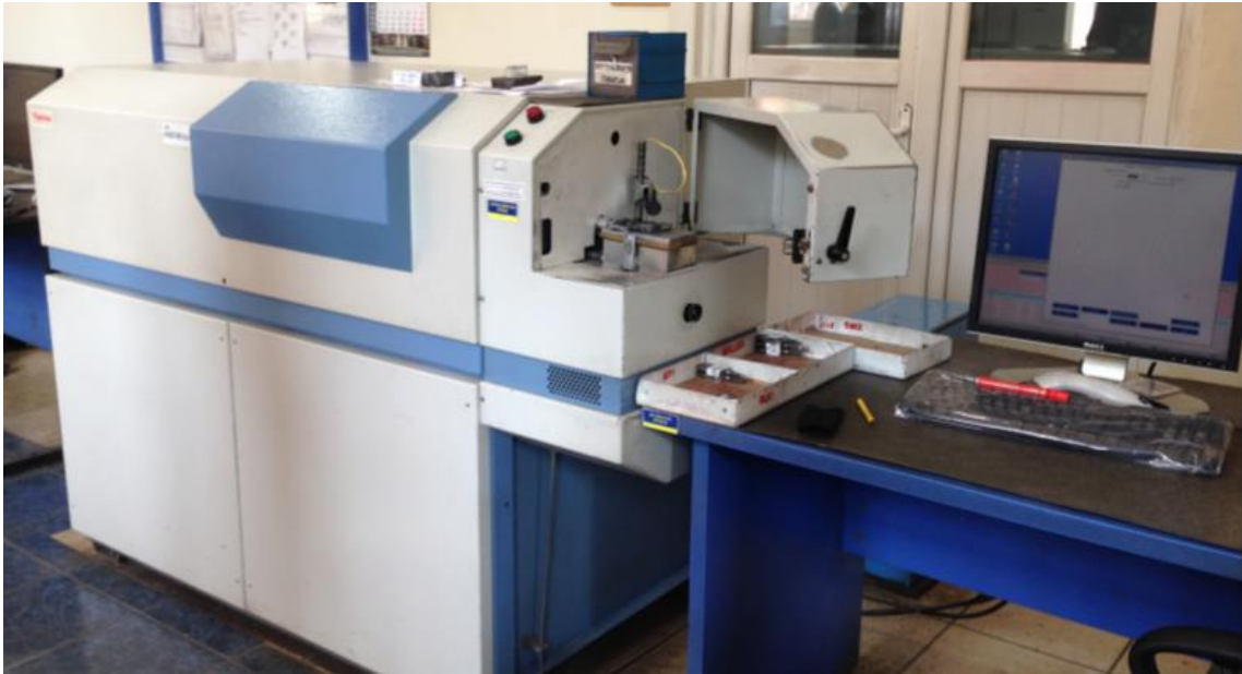
Şekil 3. 1 Thermoarl 4460 optik emisyon spektrometresi
