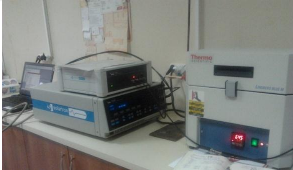
Şekil 3.15: İyonik iletkenlik ölçümünün yapıldığı empedans cihazı ve fırını.
