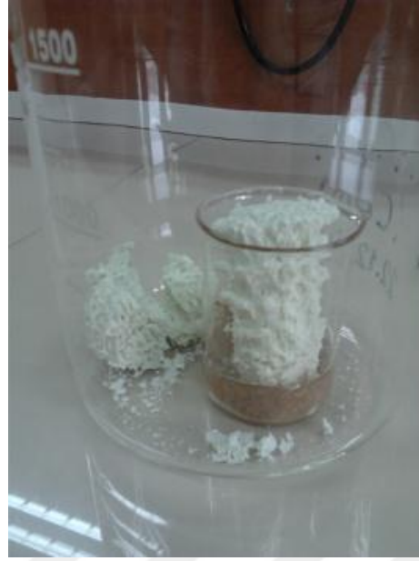
Şekil 3.5: 220°C’de 2 saat termal işlem sonrası, kül oluşumu.
