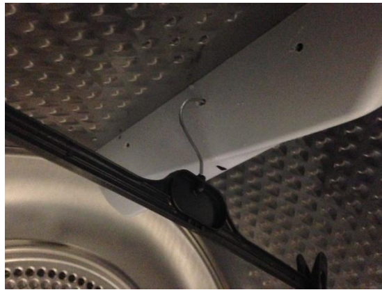
Şekil 3.1 : Tambur kanadına açılan delikler ve asılan askı.
