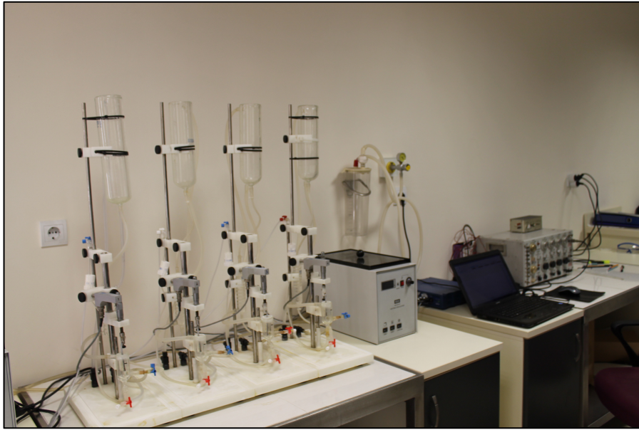
Şekil 3.3 Organ banyosu ve MP36 düzeneği
