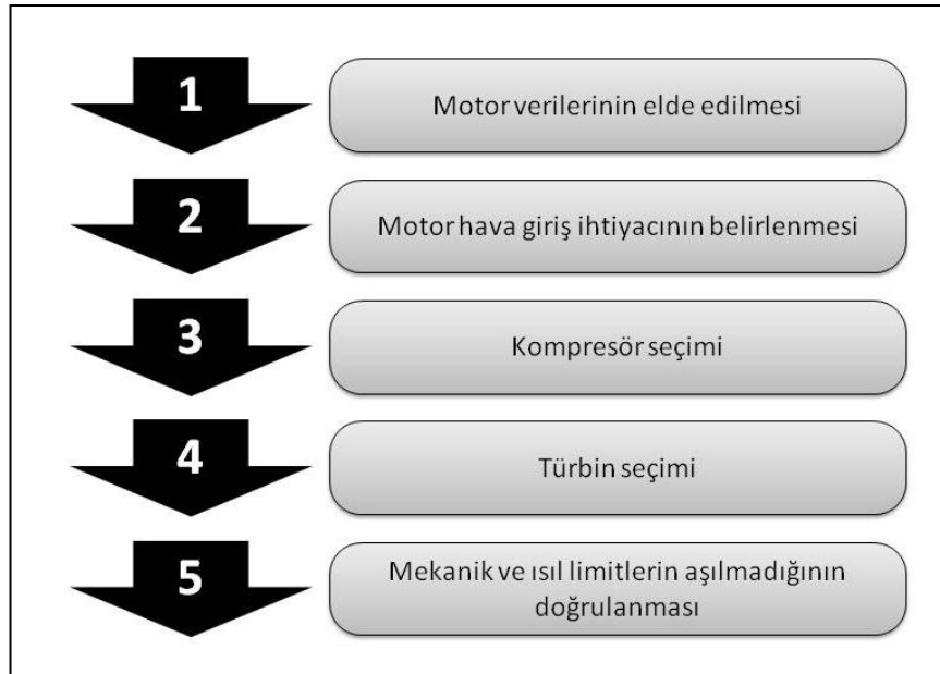
Şekil 2.18 : Turboşarj sistem seçim basamakları
