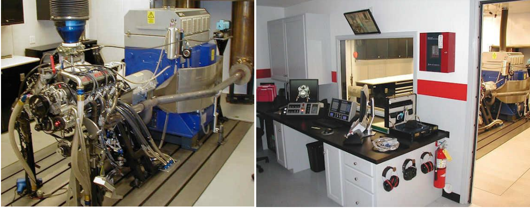
Şekil 4.5 : Dinamometre test düzeneği [26].
