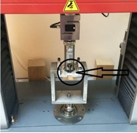
Şekil 3.1.a. Yapışma direnci test düzeneği
