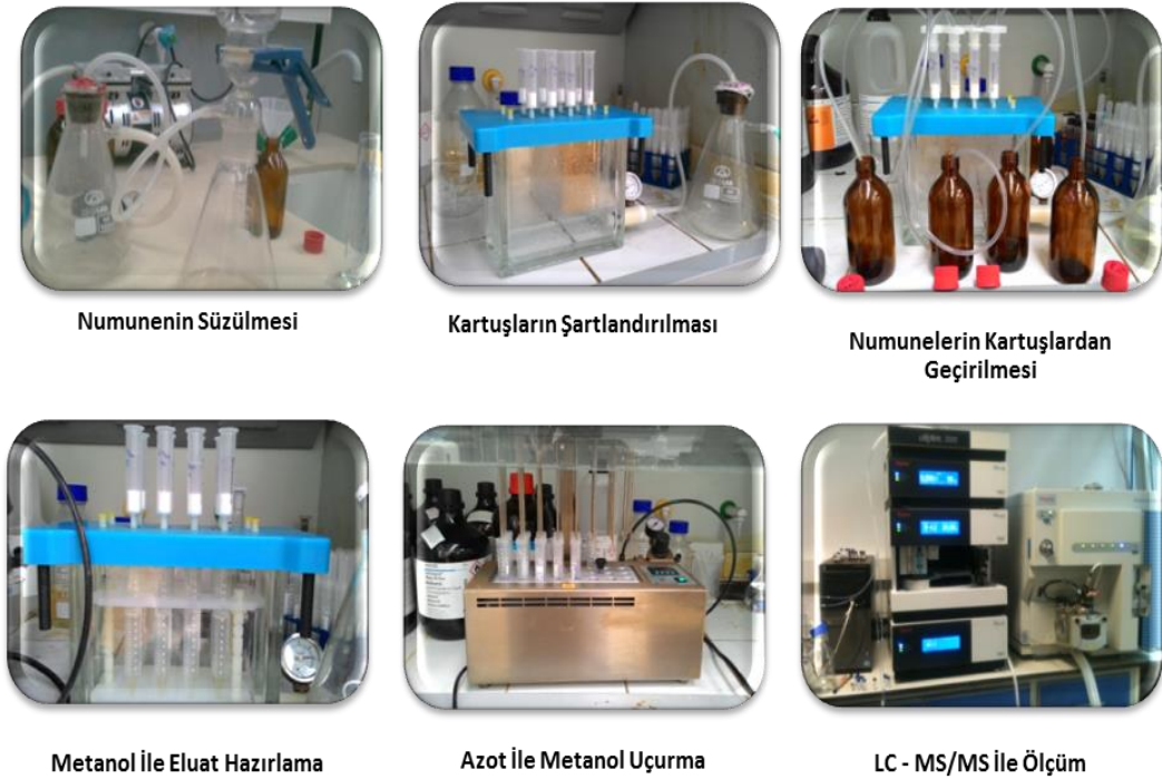
Şekil 4.7 SPE düzeneği ve SPE adımlarına ait görünömler
