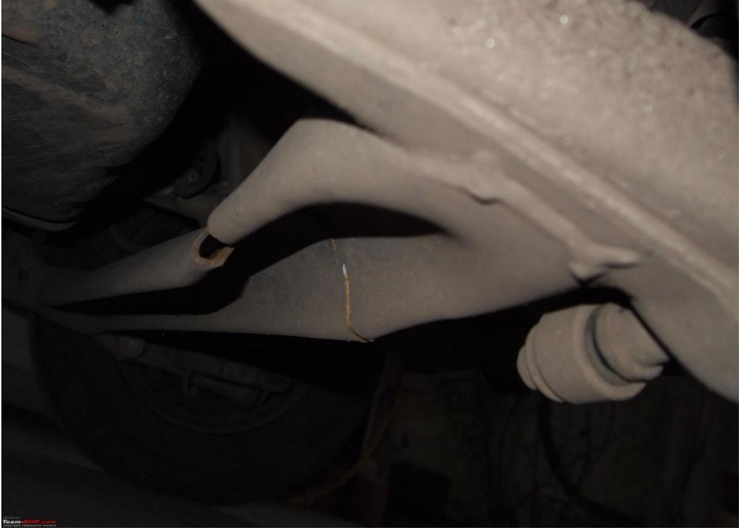
Şekil 6.11: Ara Bağlantı Borusunda Gerçekleşen Hasar Bölgesi [14].
