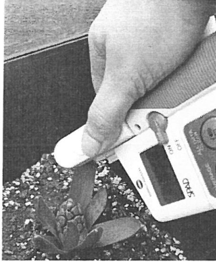
Şekil 2.14. SPAD-502 Plus klorofil ölçer cihazı ile klorofil ölçümü
