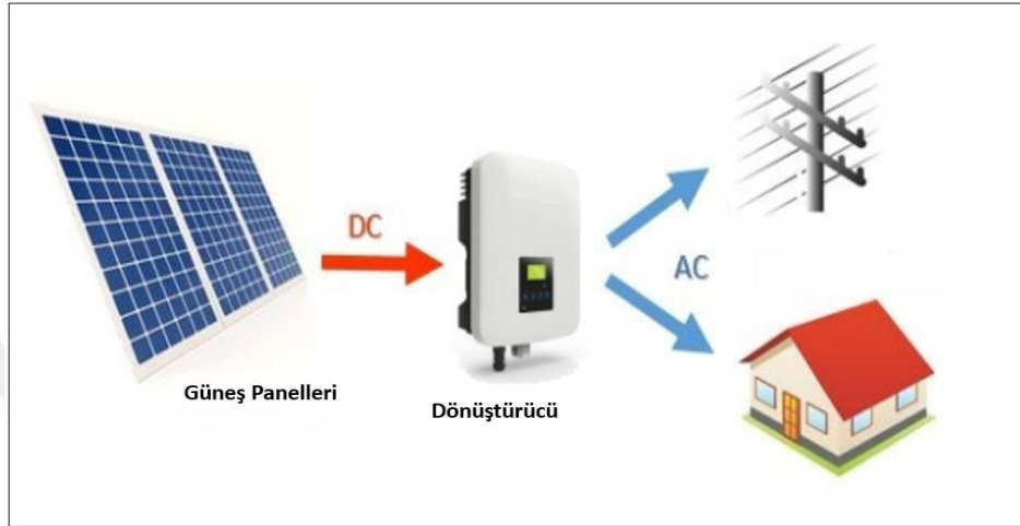
Şekil 3.17. Şebeke bağlantılı fotovoltaik sistem mimarisi (Newkirk, M. 2016)
