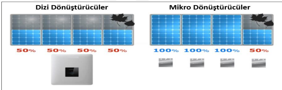
Şekil 3.14. Mikro dönüştürücü ve merkezi dönüştürücü karşılaştırılması (Carlos, 2019)
