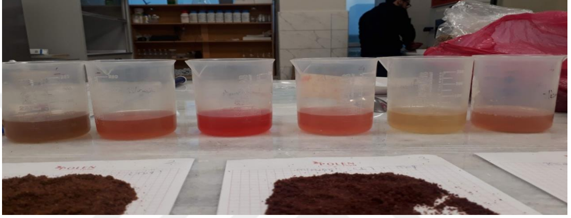
Şekil 3.4. Asitlik ve pH tayinleri için hazırlanan süzöntüler
