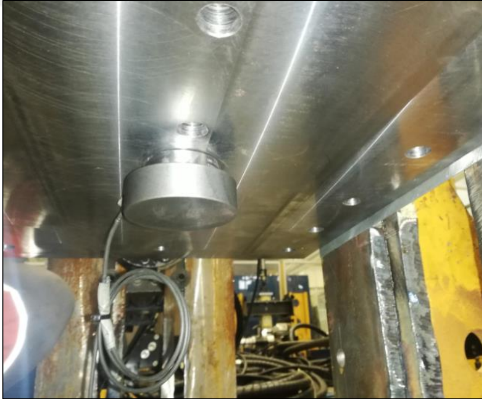
Şekil 2.6. Cıvatalı aparatla taban blok arasına sıkıştırılmış olan yük hücresi
