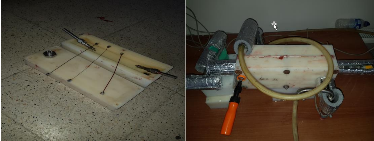
řekil 3.7 Polimer malzemededen imal edilmiř apraz akışlı ısı deęiřtirici, mini kanallar ve baęlantı elemanları.
