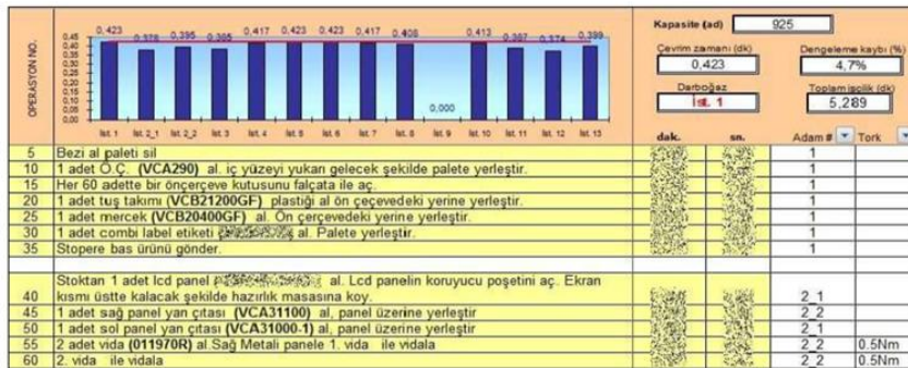
Şekil 6.17 : Montaj hattı dengeleme örneği (Şahin, 2011).
