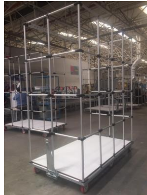
Şekil 7.46 : Strafor taşıma aracı.
