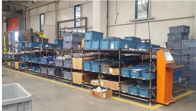
Şekil 7.41 : HAT A ve HAT B için süpermarket rafları.
