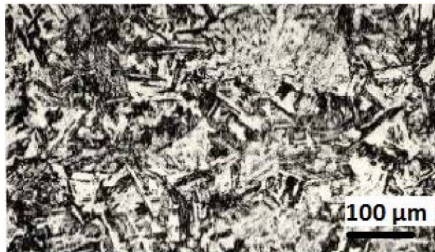
Şekil 2.16. Çökelti sertleştirilmiş paslanmaz çeliğe ait mikroyapı görüntüsü [25]
