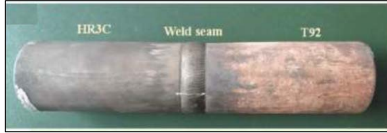
Şekil 1.5. HR3C ve T92 çeliklerinin birleştirme sonrası örnek numune görseli [15]
