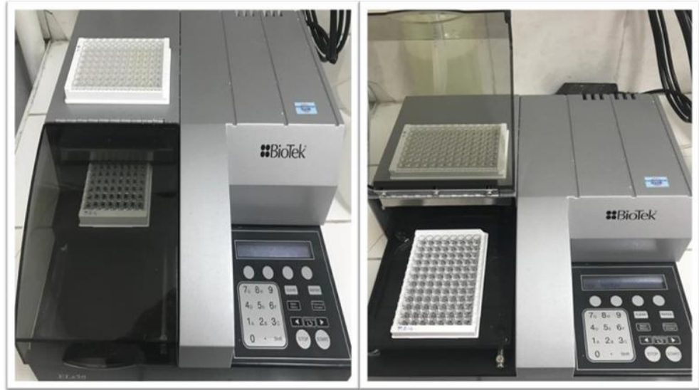
Şekil 3.14. BioTek ELx50 mikro-plaka yıkayıcı
