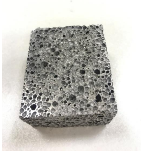
Şekil 2.6. Kapalı gözenekli alüminyum kompozit köpük (Ürkmez Taşkın, & Taşkın, 2015).
