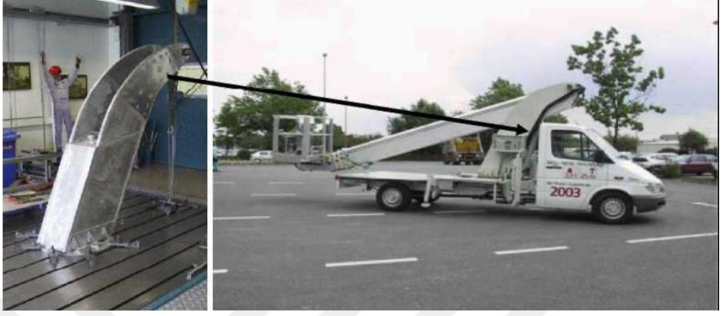
Şekil 4.2. Alüminyum hafif-ağırlıklı sandviç panel örneği (Banhart, 2003).
