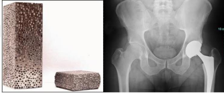
Şekil 4.8. Titanyum köpüğünden yapılan bir kalça eklemi (Marra, 2014).
