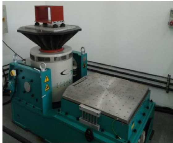
Şekil 8.6. Titreşim sarsıcı test sistemi
