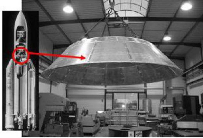
Şekil 4.5. Sandviç köpük panellerden yapılmış roket konisi (Seelinger & Banhart, 2008).
