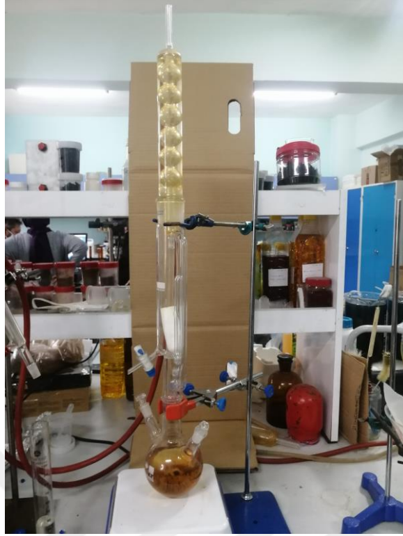
Şekil 4. 3 : İhlamur tohumu yağı soxhlet deney düzeneğimiz
