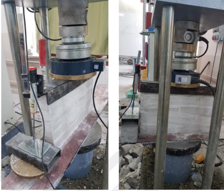
Şekil 3.6. Yığma duvar numunelerinin deney düzeneğine yerleştirilmiş hali.
