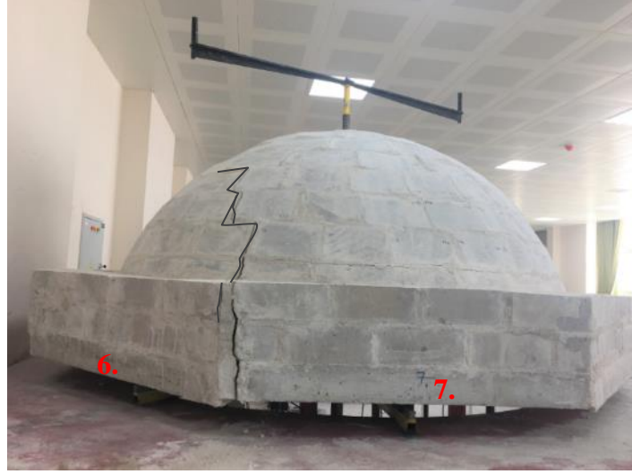
(e) 6.-7. kenarlardan başlayan çatlaklar.
