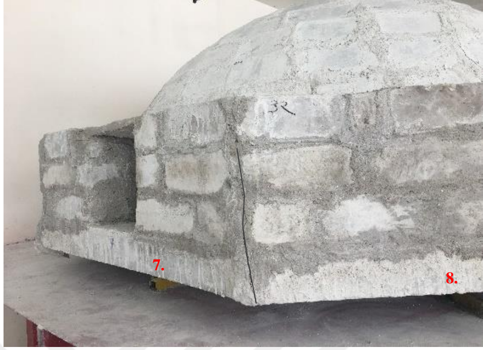
(e) 7.-8. kenarlardan başlayan çatlaklar.
