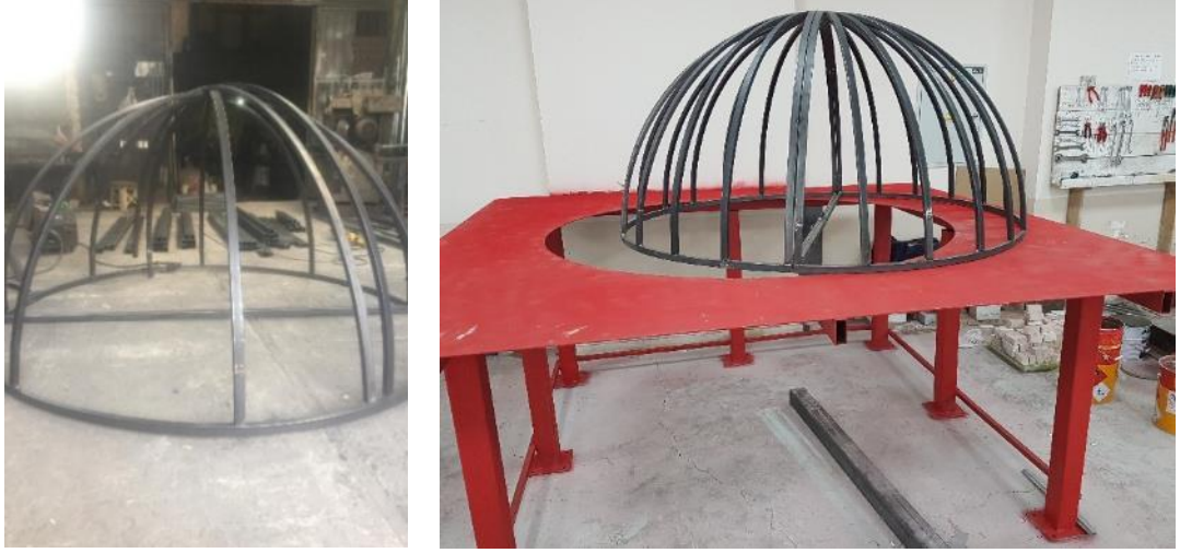
Şekil 4.3. Kubbe deney elemanları örümü için çelik kalıbın yapılması.
