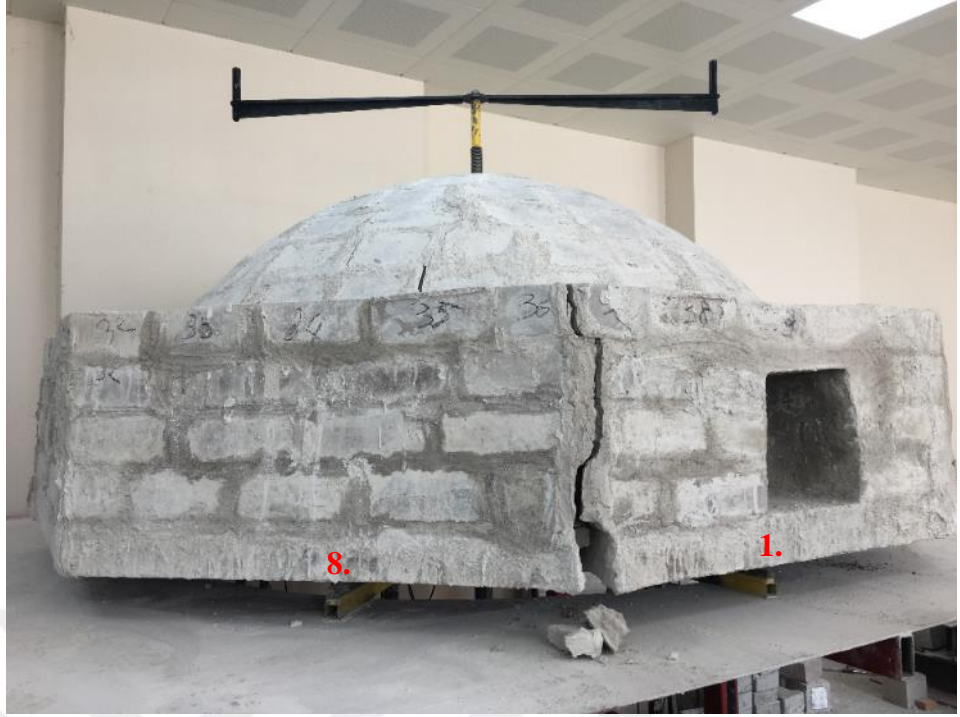
(b) 1.-8. kenarlardan başlayan çatlaklar.
