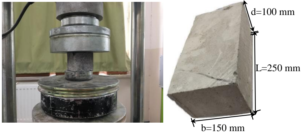
Şekil 3.1. Tuf taşın basınç dayanımı testi ve boyutları.
