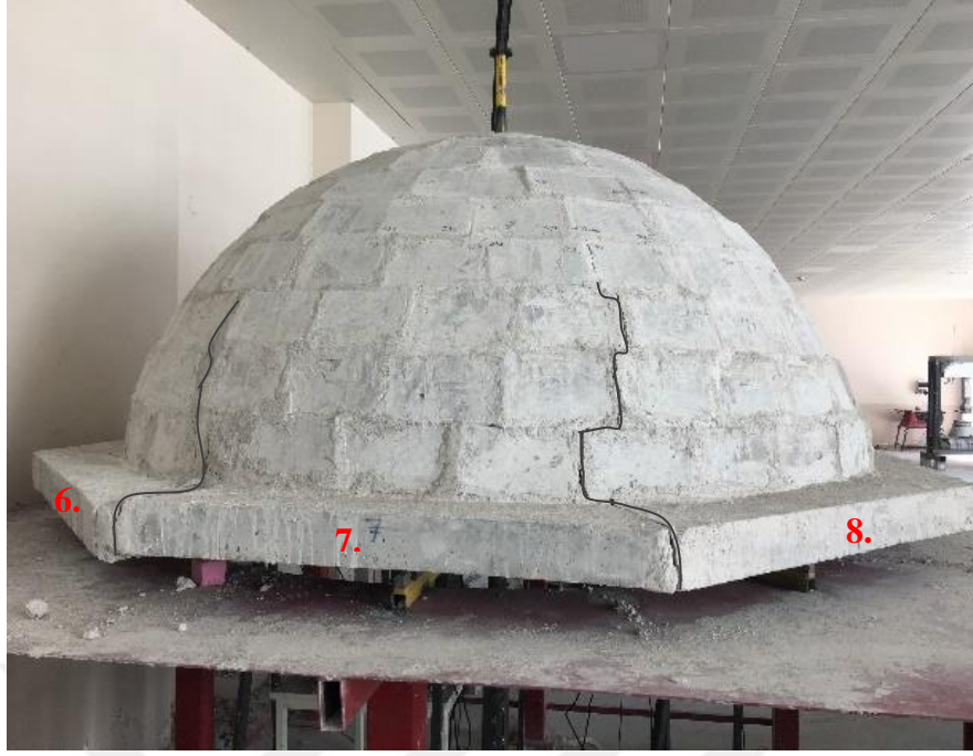
(e) 7.-8. kenarlardan başlayan çatlaklar.
