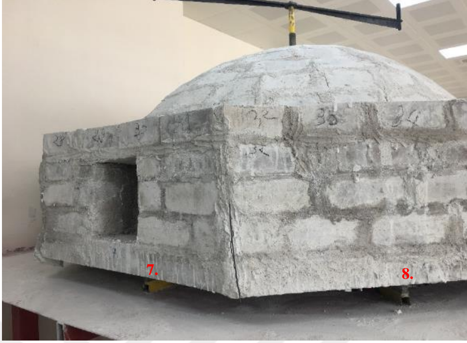
(f) 7.-8. kenarlardan başlayan çatlaklar.
