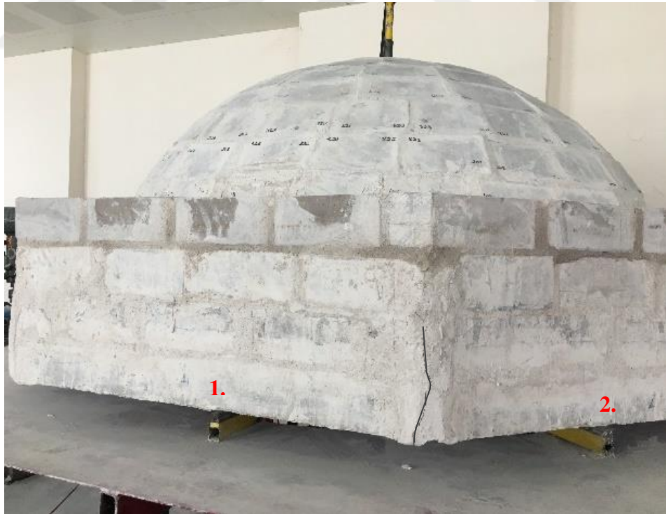
(a) 1.-2. kenarlardan başlayan çatlaklar.
