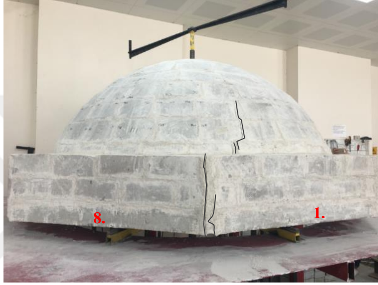
(a) 1.-8. kenarlardan başlayan çatlaklar.
