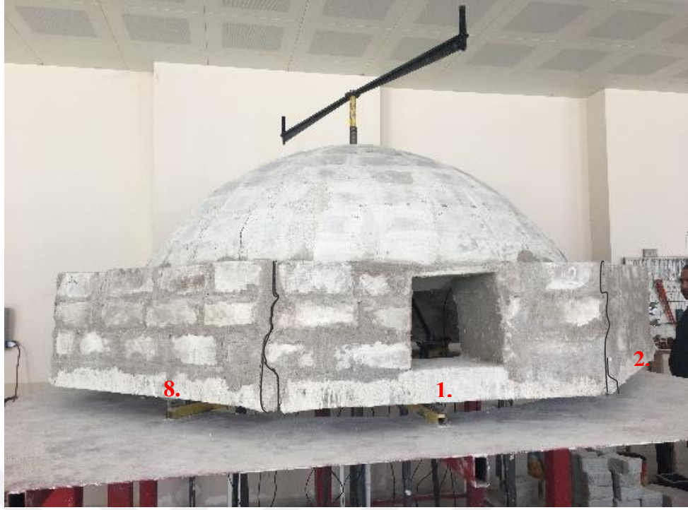
(a) 1.-8. ve 1.-2. kenarlardan başlayan çatlaklar.
