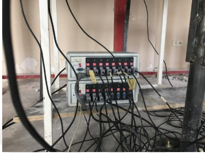
Şekil 4.7. Veri toplama cihazına LVDT’lerin ve S tipi yük hücrelerinin bağlanması.
