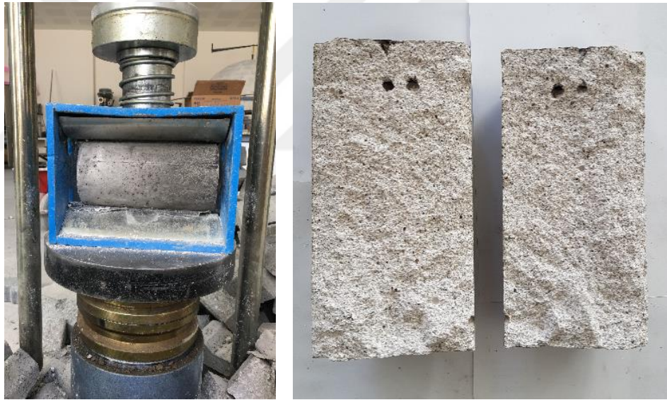
Şekil 3.4. Horasan harcın yarmada çekme dayanım testi.
