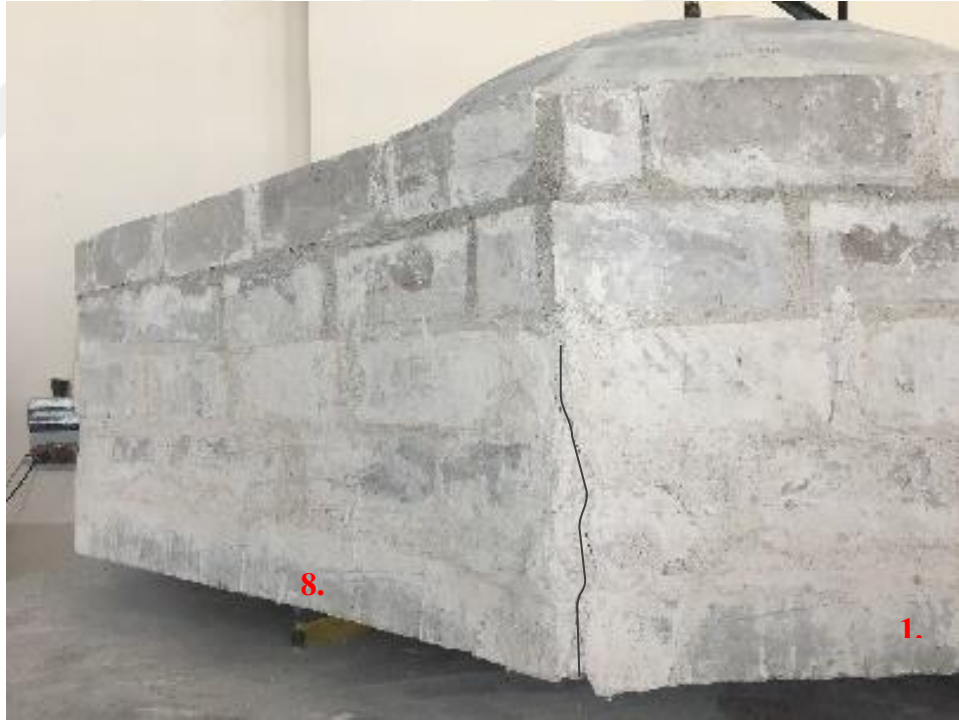
(e) 1.-8. kenarlardan başlayan çatlaklar.
