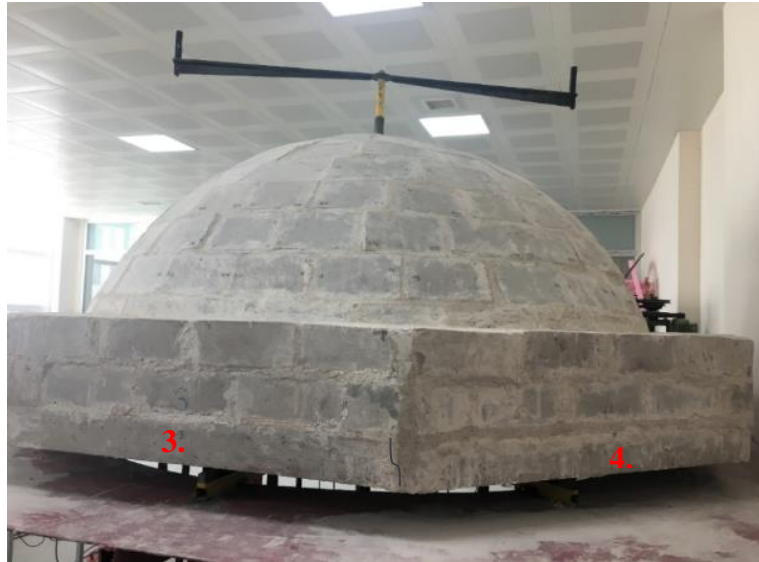
(b) 3.-4. kenarlardan başlayan çatlaklar.
