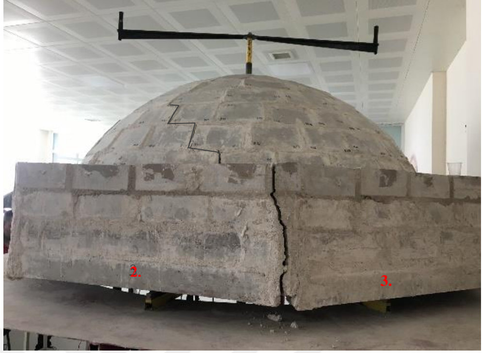
(b) 2.-3. kenarlardan başlayan çatlaklar.
