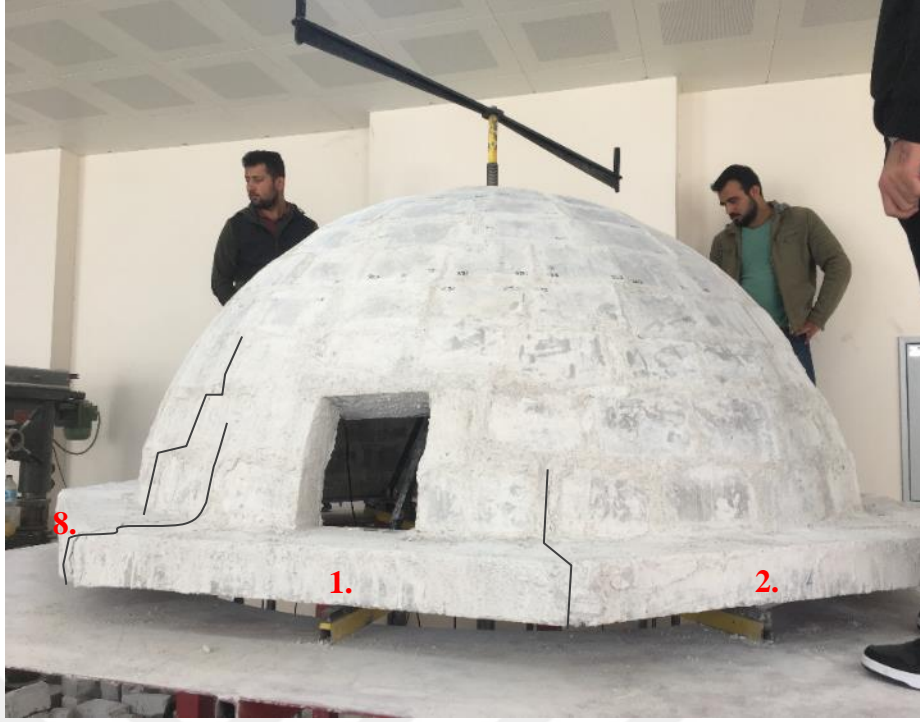
(b) 1.-2. ve 1.-8. kenarlardan başlayan çatlaklar.
