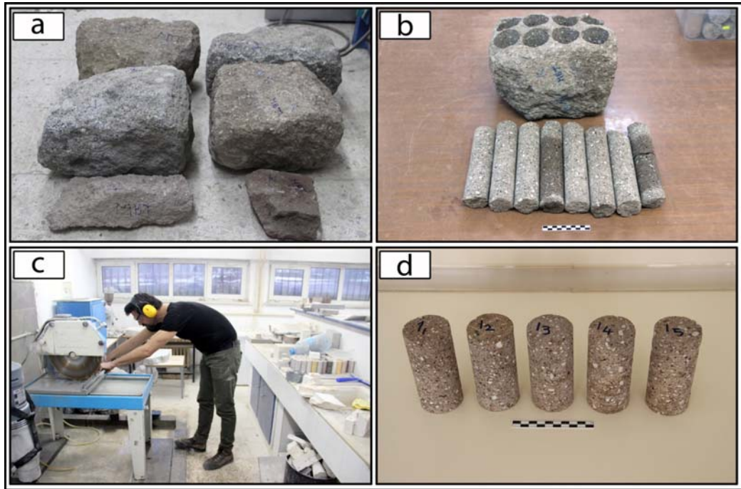
Şekil 4.13. Numunelerin hazırlanma süreçleri; a) araziden derlenen blok kayaçlar, b) ham silindirik karot örnekleri, c) boyu, çapının (54,7 mm) 2.0-2.5 katı olacak biçimde ölçülen karotların dairesel kesme makinesi ile kesilmesi, d) fiziksel özelliklerin belirlenmesine yönelik deneyler ve jeomekanik deneyler için hazır hale getirilmiş silindirik karot örnekleri.
