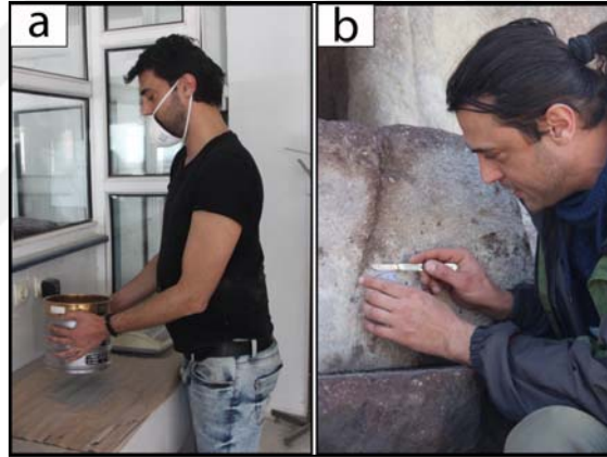
Şekil 4.14. Jeokimyasal analizler için numune hazırlama süreçleri; a) öğütülen malzemenin elek ile elenmesi, b) kabuk materyalin bisturi ile alınması.
