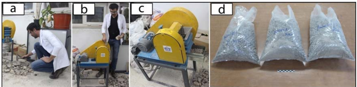
Şekil 4.18. Temsil numunelerinin parçalanma süreci; a) kırma, b) çeneli kırıcıda ufaltma, c) çeneli kırıcı ve ufaltılan malzemenin bulunduđu hazne, d) elde edilen malzeme.
