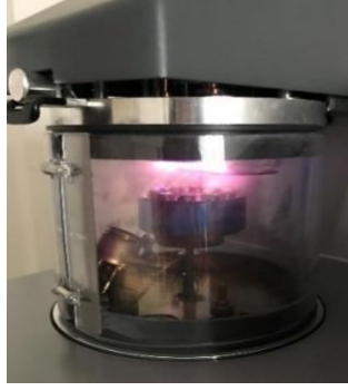
Şekil 3. 37: Örnek Yüzeylerinin Altın ile Kaplanması
