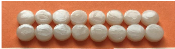
Şekil 3. 23: Manul Polisaj Uygulanmış Vita Enamic Örnekler
