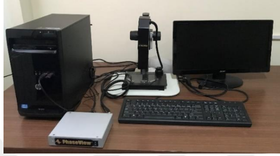
Şekil 3. 35: Phaze View / Zee Scope Optik Profilometre cihazı
