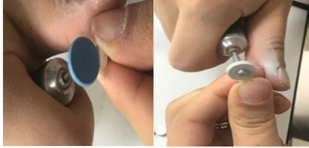
Şekil 3. 16: Polisaj Lastiklerinin Kullanılması
