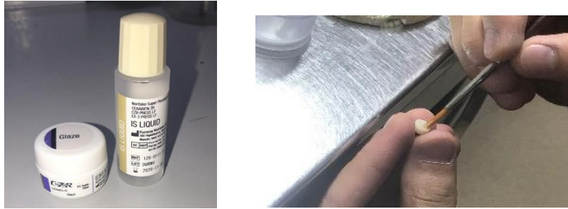
Şekil 3. 18: Örneklerle Uygulanan Glaze Ajanları ve Örnek Yüzeylerine Uygulanması
