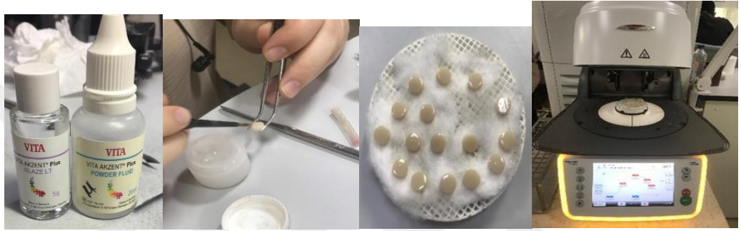
Şekil 3. 32: Glaze Materyalinin Yüze Uygulanması ve Fırınlanması
