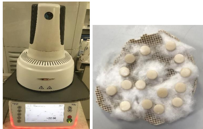
Şekil 3. 31: Vita Suprinity Örneklerin Kristalizasyonu
