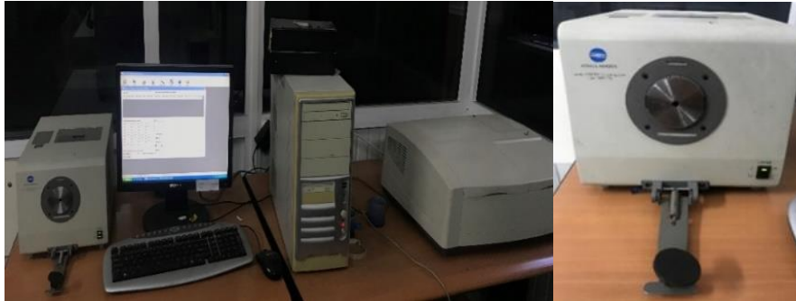
Şekil 3. 36. Konica Minolta Spectrophotometer CM-3600d Cihazı
