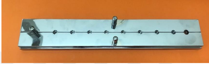
Şekil 3. 2: Feldspatik Porselenin Hazırlanacağı Metal Kalıp
