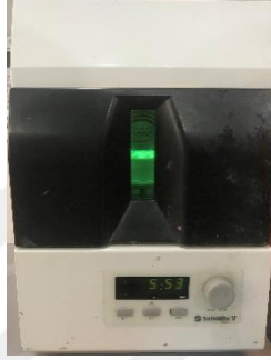
Şekil 3. 25: Shofu Solidilite V dental laboratuvar ışıkla sertleştirme cihaz
