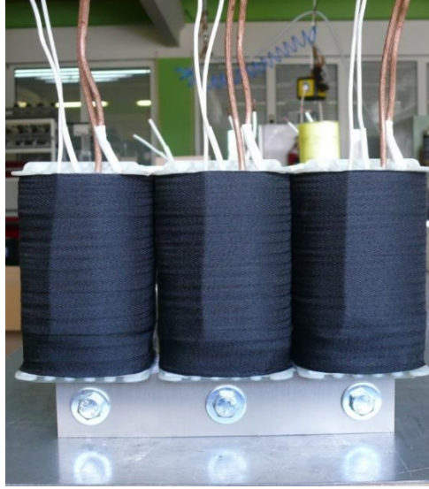
Şekil 5.76 Bobinlerin bacak paketi üzerine yerleştirilmesi
