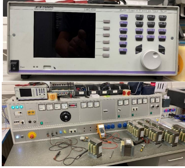
Şekil 5.80 Zimmer LMG-450 Güç Analizörü ve Güç Kaynağı
