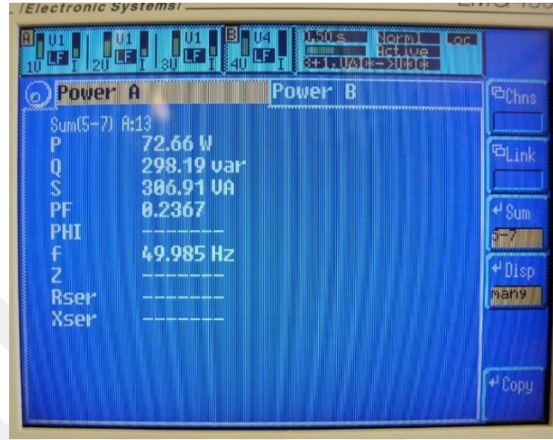
Şekil 5.82 Plug-In çekirdek modeli için ölçülen boşta kayıp değeri
