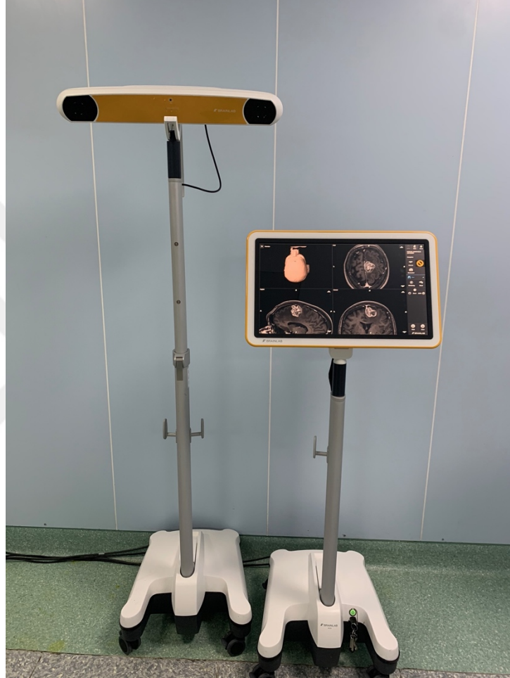
Şekil 2. Rutin kullanımda olan Optik Tabanlı Nöronavigasyon Sistemi. Sağda dokunmatik ekrana sahip monitör ve solda kızılötesi kameraya sahip optik takip sistemi (OTS).
