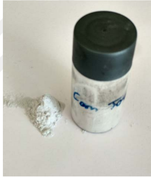
Şekil 2.8. Ekstrüzyon işleminde kullanılan yağlayıcılar.
