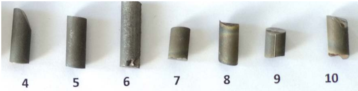
Şekil 2.5. Tel erozyon yöntemi ile elde edilen 6 mm çapında silindirik örnekler.
