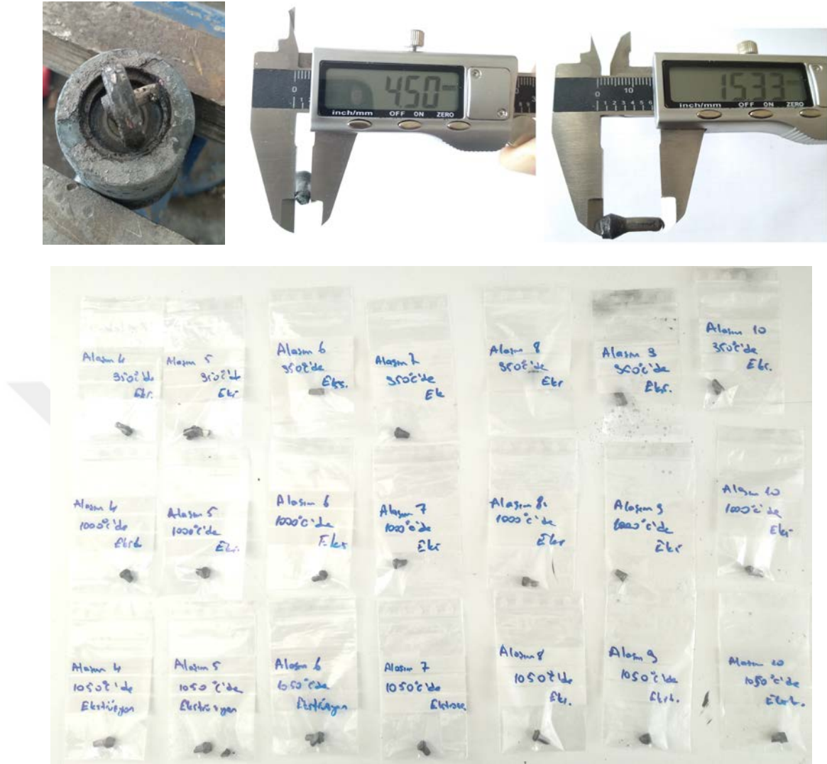
Şekil 2.9. Ekstrüzyon işlemi sonrası elde edilen örnekler.
