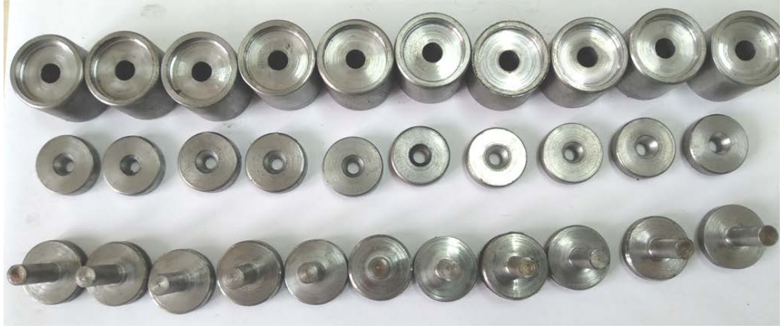
Şekil 2.7. Elde edilen ekstrüzyon kalıpları.
