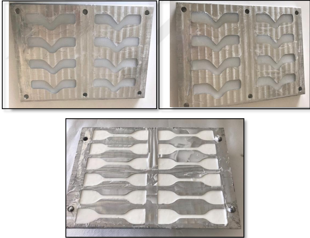
Şekil 4.7 Nanopartikül ilave edilmiş silikonun metal kalıplara yerleştirilmesi
