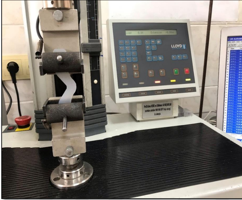
Şekil 4.17. Yırtılma dayanımı testi için cihaza yerleştirilmiş silikon örnek
