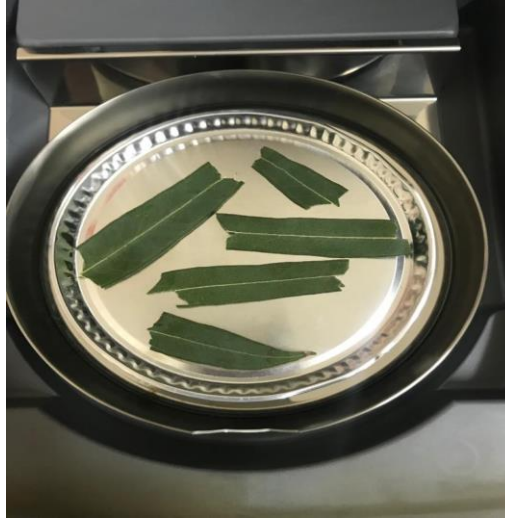
Şekil 4.4. OHAUS IR ile Okaliptüs başlangıç nem tayini.
