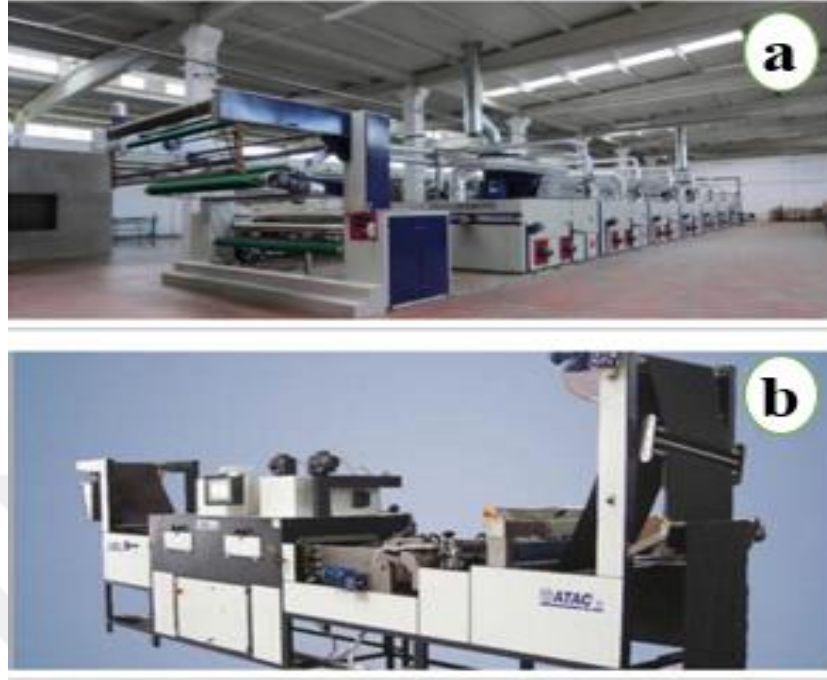
Şekil 2.12. Ramöz makinaları a: İşletme tipi ramöz makinası b: Labaratuvar tipi ramöz makinası.
