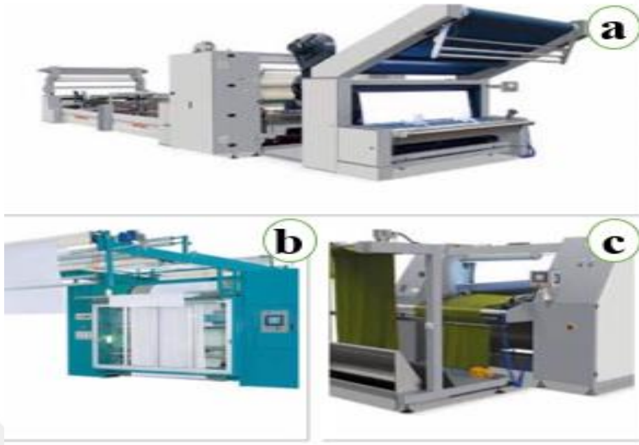
Şekil 2.13. Kuru bitim işlem makinaları a: Açık en sanfor makinası b: Şardon makinası c: Tüp sanfor makinası.
